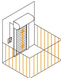
**Betätigung mit Schalter, Sender und Automatiksteuerung**
