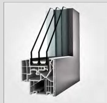
Die schmale Bautiefe von 71 mm und der innovative Glasflügel machen das KF 320 zu einem beliebten Produkt. Die spezielle Flügelkonstruktion hat die Anmutung einer Fixverglasung, ist aber ein zu öffnendes Fenster. Wird der Rahmen in das Mauerwerk eingeputzt, so entsteht eine nahezu rahmenlose Glasarchitektur. I-tec Glazing sorgt durch eine Rundumverklebung der Glasscheibe für ausgezeichnete Stabilität, Wärmedämmung und Sicherheit. Erhältlich auch als Kunststoff-Aluminium Ausführung.
